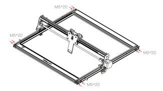
4. 安装三个脚架以及控制盒组件: 一共使用 8 颗 M5\*20 内六角平圆头螺丝锁紧。
