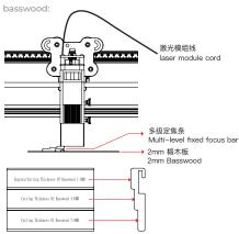
注意激光模组必须在断电状态下才能安装与拆卸。
