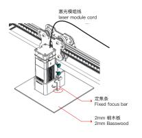
5.2 安装 10W 激光模组: 请将多级定焦条放置在模组与加工 材料之间,按照定焦条表面的镭雕提示,使激光模组护目罩底 部与多级定焦条对应位置相接触,最后使用右侧的手拧螺丝将 其锁紧。例如雕刻或者切割 2mm 厚的椴木板:
